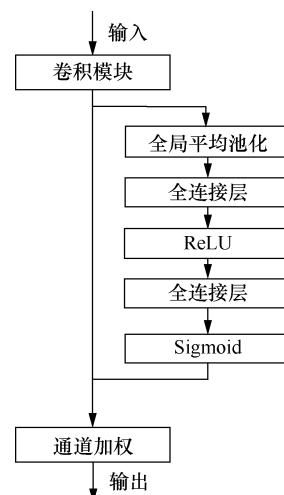
图 5 SENet 的网络结构
